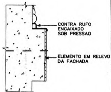
ARREIMATE DE ELEMENTO EM RELEVO DA FACHADA
